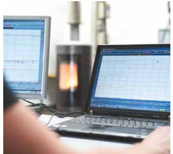
Abb. 3 Dieser Prototyp wird umfangreichen Tests unterzogen. Erst wenn die Hark-Techniker vollständig zufrieden sind, geht der Prototyp zur vorgeschriebenen Feuerstättenprüfung an eine unabhängige Prüfstelle, wird mit dem CE-Zeichen ausgestattet und kann in die serienmäßige Produktion aufgenommen werden.
