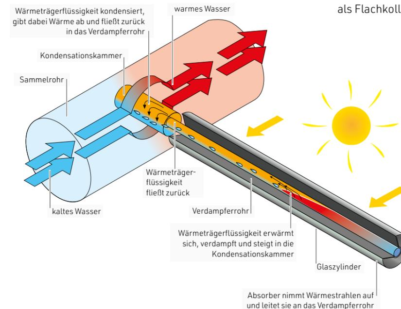
ferrohr weitergeleitet. Die darin eingeschlossene Flüssigkeit verdampft schon bei relativ niedrigen Temperaturen (ca. 25°C). Der Dampf steigt, physikalisch bedingt, im Verdampferrohr bis in die Kondensationskammer hinauf. Damit dies funktionieren kann, benötigen die Kollektoren einen Aufstellwinkel zwischen 25 und 65 Grad.
