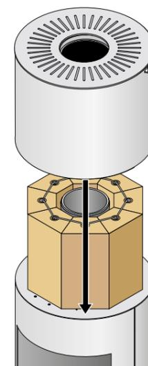
Konvektionsluftsteuerung: regelbar und verschließbar
